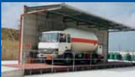
PESA A PONTE LPM 18X3 m 80 t h.40 cm. IN VERSIONE SOPRAELEVATA ESECUZIONE ANTIDIFLAGRANTE (EEx) PER AREA A RISCHIO DI ESPLOSIONE PESATURA SU BAIA DI CARICO PER GAS GPL
