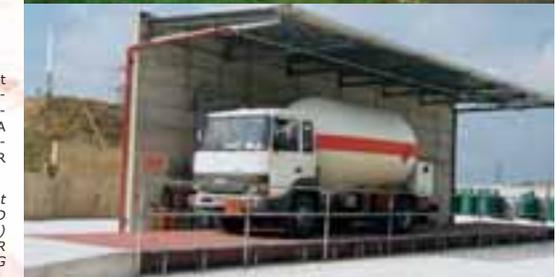
PESA A PONTE LPM 18X3 m 80 t h.40 cm. IN VERSIONE SOPRAELEVATA ESECUZIONE ANTIDIFLAGRANTE (EEx) PER AREA A RISCHIO DI ESPLOSIONE PESATURA SU BAIA DI CARICO PER GAS GPL
