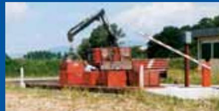
PESA A PONTE LPM 14X3 m 60 t h. 40 cm. IN VERSIONE SOPRALEVATA FASI DI COLLAUDO METRICO
